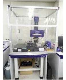
(写真) 触針式表面粗さ形状測定機
